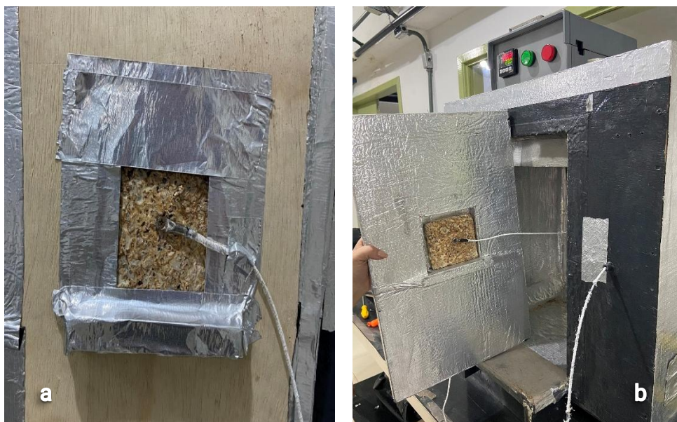
Figura 38 – Sensor posicionado simultaneamente na amostra pelo lado externo da caixa (a) e pelo lado interno (b).
