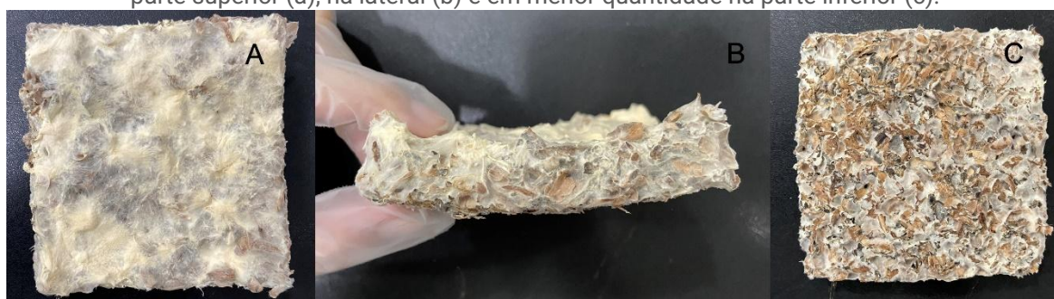
Figura 35 – Resultado da amostra (CP1) desmoldada, indicando a pele fúngica mais espessa na parte superior (a), na lateral (b) e em menor quantidade na parte inferior (c).
