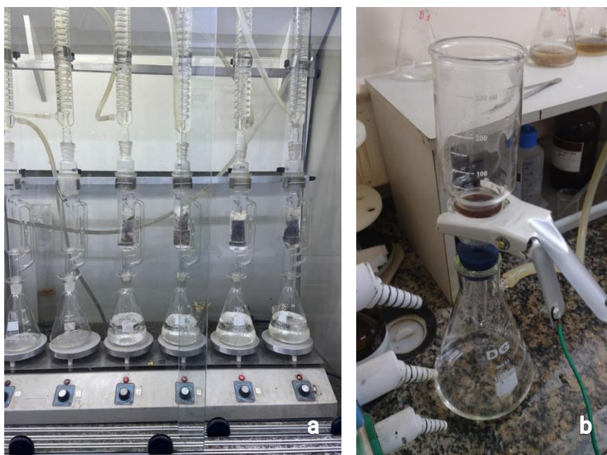
Figura 26– Processo para determinação de extrativos, utilizando equipamento extrator do tipo Soxlhert com ciclohexano (a), e posterior filtragem (b).
