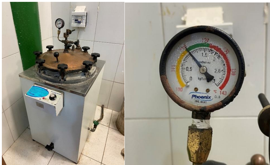
Figura 31 – Autoclave e manômetro apontando para a temperatura utilizada na esterilização: 120°C.
