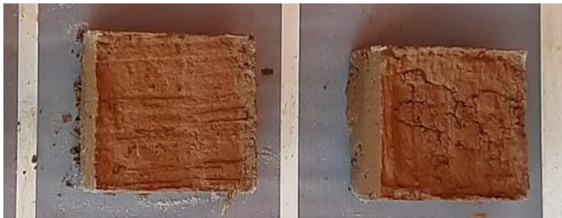
Figura 23 - Comparação fissuração bloco com acréscimo de fibras(esquerda) com bloco sem acréscimo de fibras(direita)
