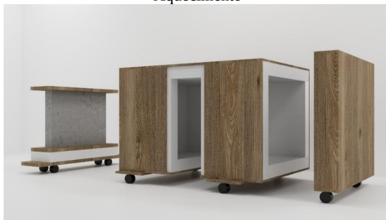
Figura 21 – (a) Carrinho para suporte dos Painéis; (b) Câmara; (c) Módulo de Aquecimento
