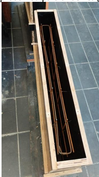
Figura 19 – Fôrma produzida para a fabricação dos bioconcretos
