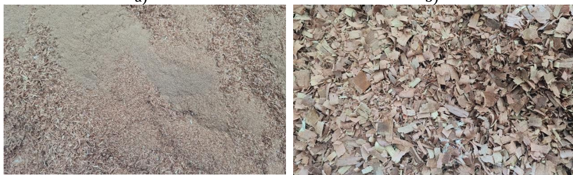
Figura 12 – a) Fração < 1,18 mm b) Fração > 1,18 mm
