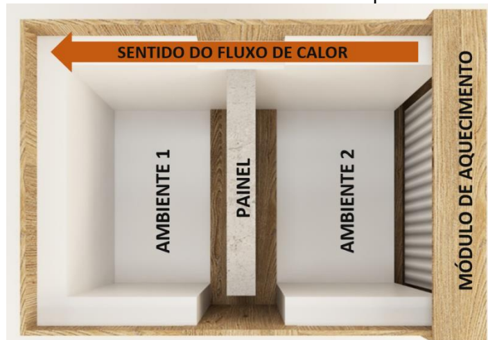
Figura 23 – Setores da Câmara Térmica: Módulo de Aquecimento e Painel Divisor
