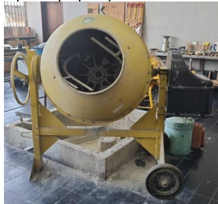
Figura 18 – Betoneira de 150L e 400L utilizada para a preparação dos bioconcretos
