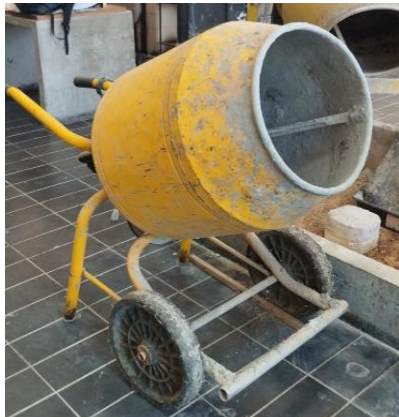
Figura 18 – Betoneira de 150L e 400L utilizada para a preparação dos bioconcretos
