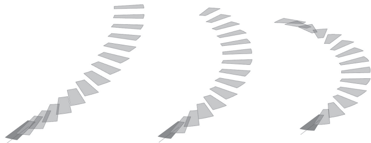
Figura 6: Script proposto: variação no ângulo dos degraus e raio médio. Fonte: o autor, 2023.
